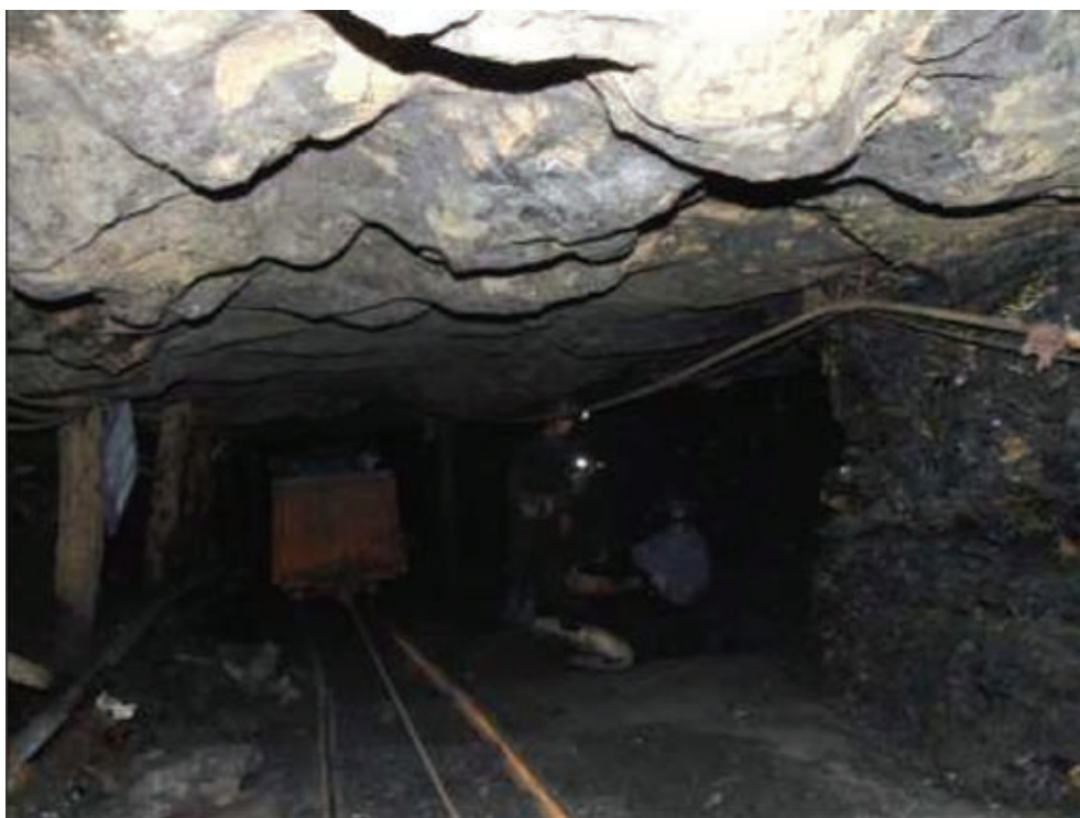
圖5-4：開採斜井及礦車鋼絲繩運輸
